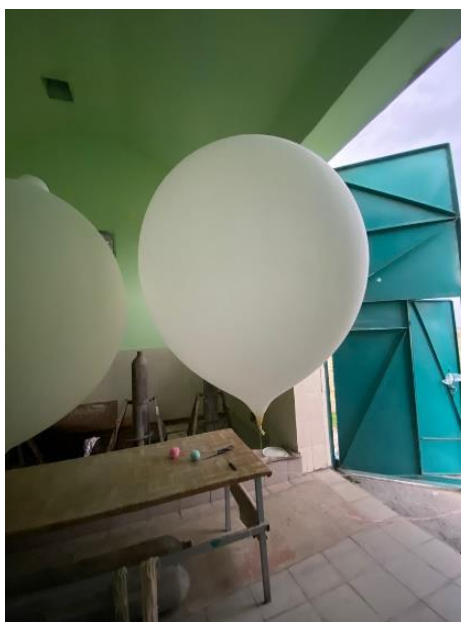
Рисунок 1.4 – Латексный шар, наполненный водородом, который достигает высоты до 50 км.
