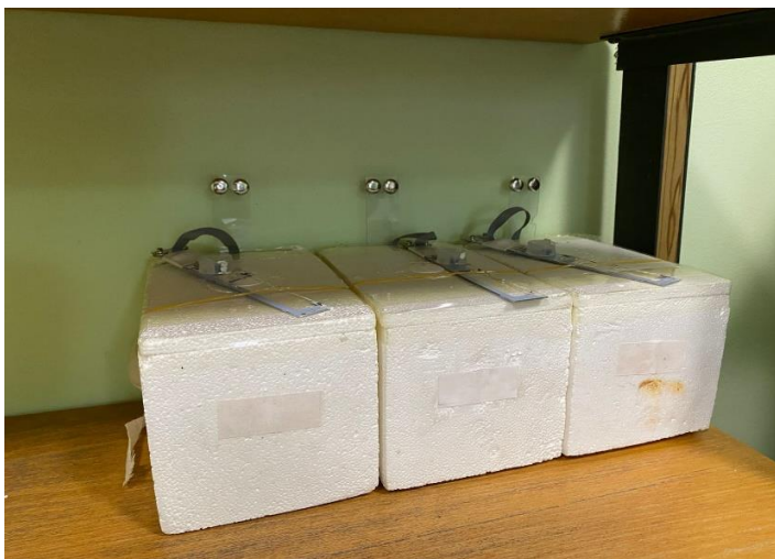
Рисунок 1.1 – Зонды без крепления к водородному шару.
